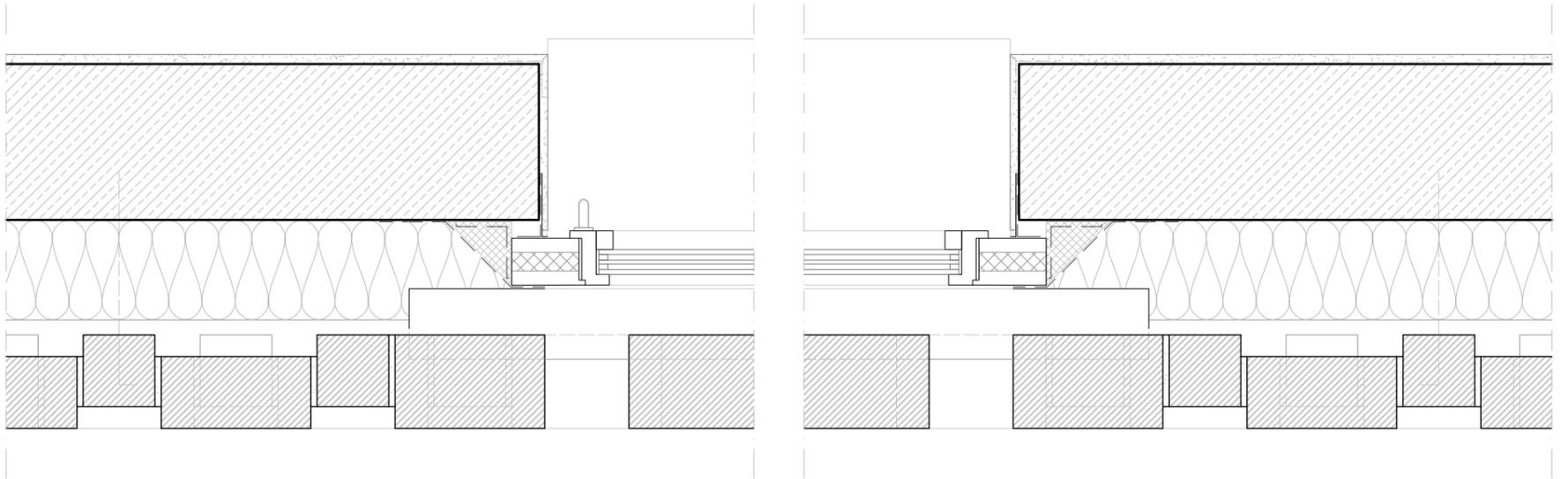
Vertikalschnitt: Südfassade 1.OG, Fensteranschluss
